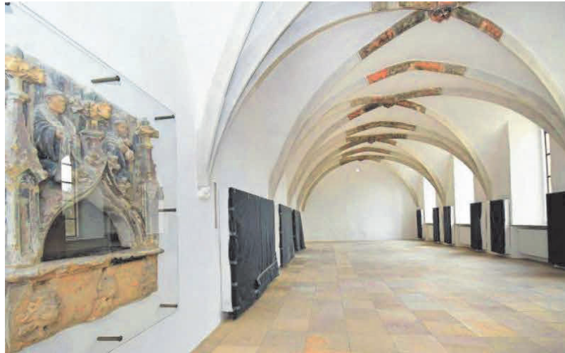
Im Refektorium, einem der wertvollsten Räume der ganzen Burganlage, erinnert das prunkvolle Handwaschbecken (vorne links), geschützt durch Glas, an vergangene Zeiten. Und die (noch dunkel verpackten) Schallschutz-Elemente (im Hintergrund) an die besondere Herausforderung, alte Bausubstanz denkmalgerecht zu erhalten und trotzdem modern nutzbar zu machen.
